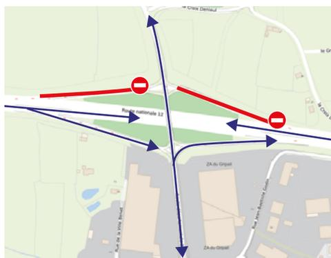
Réalisation du giratoire avec fermeture des bretelles d'entrée et de sortie au nord de la RN12. Une déviation sera mise en place.
